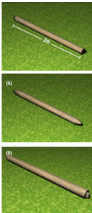
10. Prepare as pontas dos mourões ou peças que servirão de travamento para a estrutura de ancoragem da cerca ou “palanque”, usando plaina/enxó (A) ou formão/serrote/enxó (B). (ver ilustrações de ferramentas página 24)
