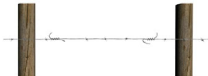
**7.** Nunca aplique os grampos sobre os fios da cerca pressionando-os nos mourões. Este procedimento evita que o arame corra dentro do grampo e danifica a estrutura do arame criando pontos de enfraquecimento do fio.
