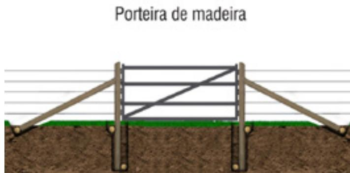
Cercas de arame liso com palanques ancorados com morto não permitem o seccionamento já que os rabichos funcionam como aterramentos próximos.
